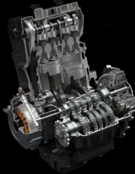
Motore bicilindrico parallelo da 776 cm<sup>3</sup>, 4 tempi, raffreddato a liquido, DOHC
