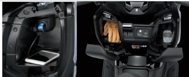
\* Il peso massimo totale ammesso nel vano sottosella è di 10 kg
